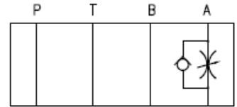
Versione con regolazione sulla porta A Model with regulation on port A
