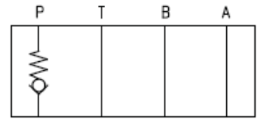
Versione con regolazione sulla porta P Model with regulation on port P
